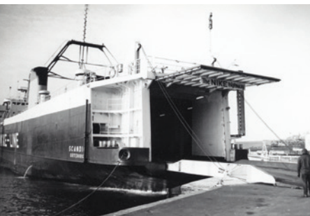
Ro/Ro skibet "Scandia" lægger bagklappen på kajen, mens stævnens skibsskruer holder det på plads.
